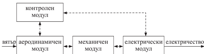
Фигура 1.12. Модули на вятърен електрогенератор (вятърна турбина)
